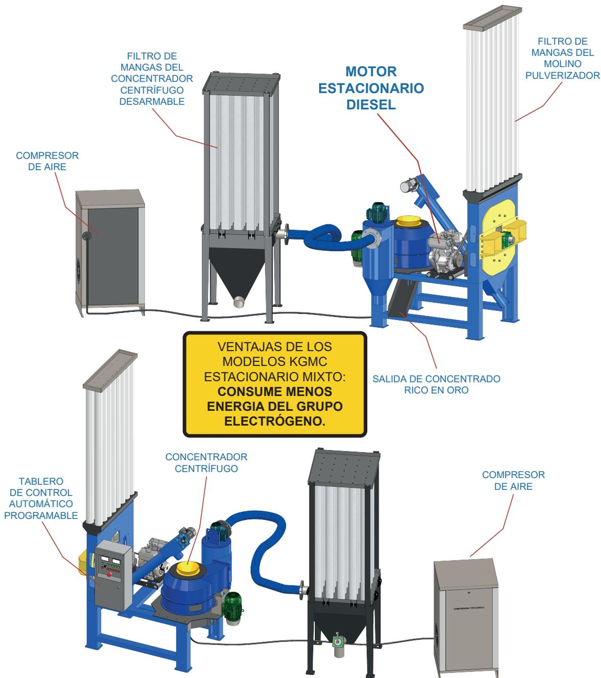
El Equipo KGMC usa piezas que sufren desgaste en el proceso de Molienda - Pulverización, para ello es necesario reemplazar dichas piezas para continuar con el funcionamiento de la máquina. Estas piezas, denominadas consumibles, se deben reemplazar después de procesar la cantidad de toneladas detalladas a continuación:
