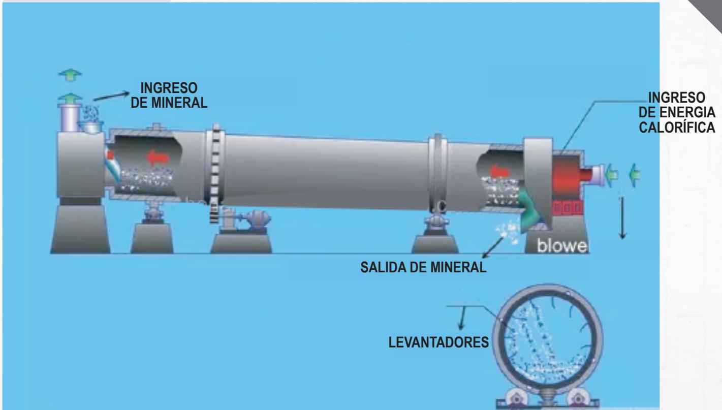
Estructura interna de la elevación tipo de placa del Secador Rotativo KGMC:
